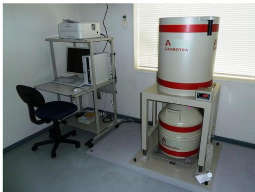
(写真：キャンベラ社製ゲルマニウム半導体検出器-放射能測定機器)
